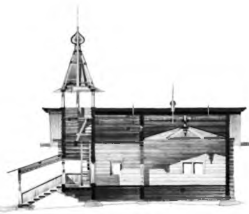
Часовня в деревне Усть-Поча. Продольный и поперечный разрезы. Реконструкция
