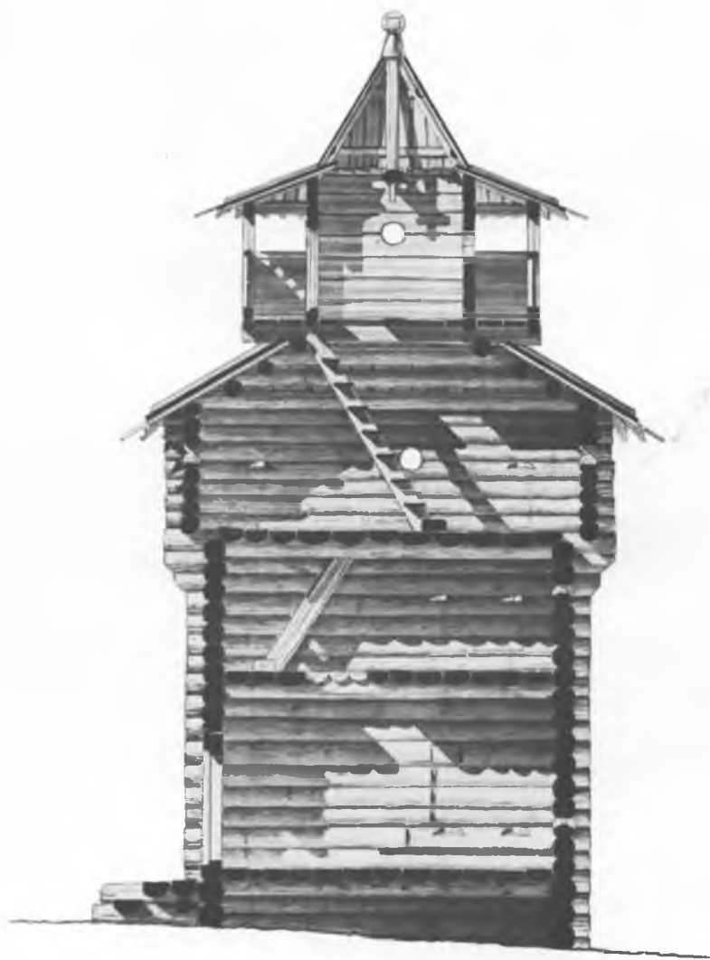
Башня Бельского ostroga. Разрез. Реконструкция
