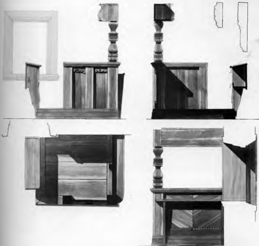
Покровская церковь близ Вытегры. Клирс и его детали. Обмер
