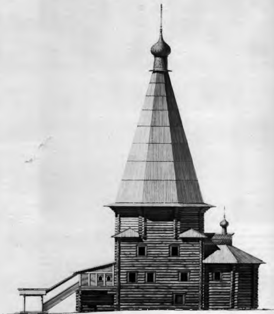
Дмитриевская церковь в селе Верхня Уфтуга. Южный фасад. Реконструкция
