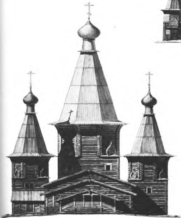
Успенский собор в Кем до реставрации. Восточный фасад. Обмер
