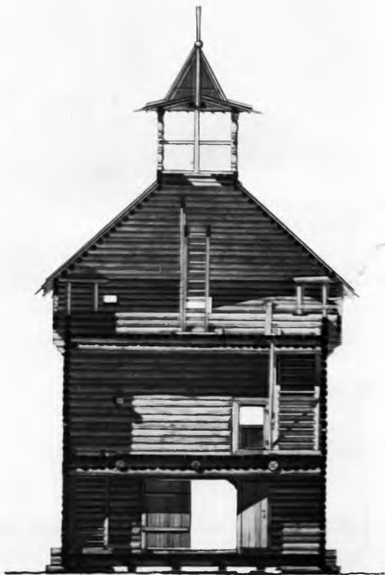
Башня Якутского острога. Разрез. Реконструкция
